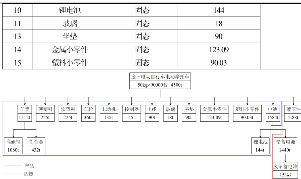
图 2-1 废旧电动车拆解物料平衡图
